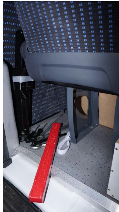
Warndreieck + Wagenheber hinter Hecktüre links
